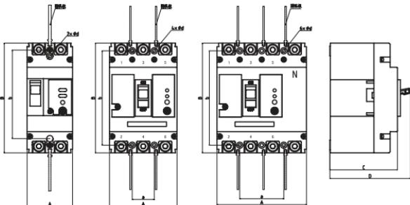
图3 外形尺寸及安装尺寸
