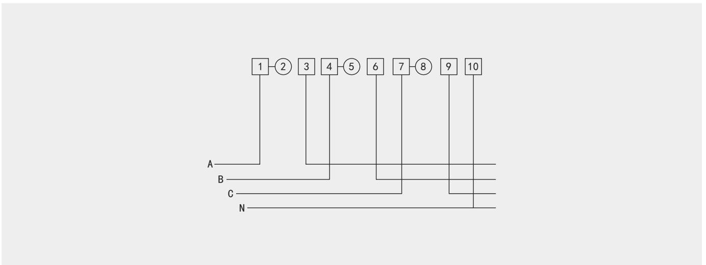
c、电流、电压互感器式： $3 \times 57.7/100V, 3 \times 1.5(6)A$
