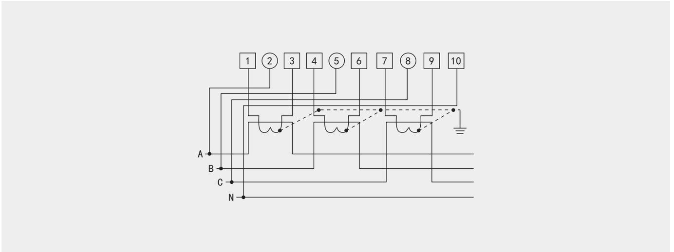
b、直接式： $3 \times 220/380V, \geq 3 \times 5(20)A$
