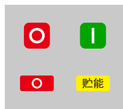
断路器断开且已储能完毕状态
