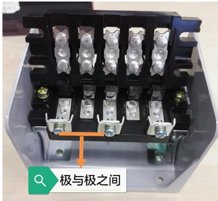
电气间隙和爬电距离示意图
